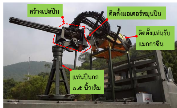
รูปที่ 7 ประกอบระบบปืนและติดตั้งบนรถจีเอ็มซี
