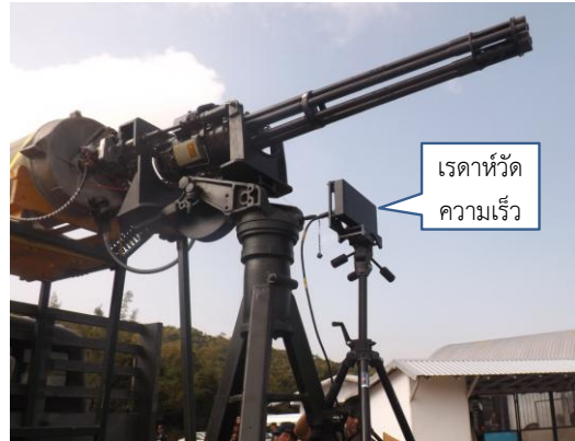
รูปที่ 9 เจ้าหน้าที่กองทดสอบฯ ติดตั้งเรดาร์วัดความเร็วต้นกระสุนปืน
